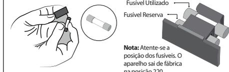
**3** Após substituir os fusíveis, reposicione o suporte com cuidado em seu devido lugar.
